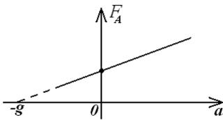
Как видно из графика, при движении сосуда с ускорением  $a = g$ , направленным вертикально вниз, на тело, погруженное в жидкость, сила Архимеда не действует, т.е. в невесомости  $F_A = 0$ .
