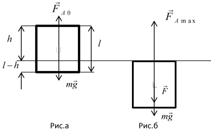
а) На куб, плавающий в жидкости, действуют сила тяжести  $m\vec{g}$  и равная ей сила Архимеда  $\vec{F}_{A_0}$ , т.е.  $mg = F_{A_0}$  (1) (рис. а). При погружении куба в жидкость сила Архимеда увеличивается от  $\vec{F}_{A_0}$  до максимального значения  $F_{A_{\max}} = \rho_{ж} g l^3$  (2) в момент, когда куб будет полностью находиться в жидкости (рис. б). Сила  $\vec{F}$ , удерживающая тело в жидкости, также увеличивается и
