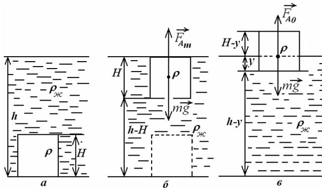
При движении цилиндра в воде на него действуют силы тяжести  $m\vec{g}$  и Архимеда  $\vec{F}_A$ , причём при движении цилиндра до поверхности воды сила Архимеда будет постоянна и равна максимальному значению  $F_{A\text{max}} = \rho_{\text{ж}} S H g$  (рис. б). Площадь основания цилиндра  $S = \pi R^2$ , объём цилиндра  $V = S H = \pi R^2 H$  равен объёму вытесняемой им воды, то сила Архимеда  $F_{A\text{max}} = \rho_{\text{ж}} \pi R^2 H g$ .
