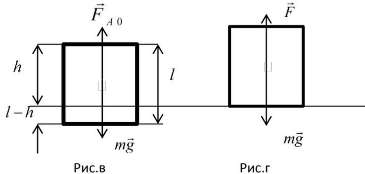
Работа этой переменной силы при перемещении куба на  $(l-h)$  равна  $A_2 = F_{cp} \cdot (l-h)$  (8).
